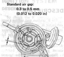
EE701 Fig. EE-62 Air Gap
