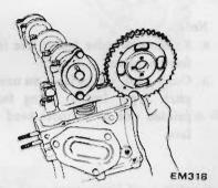
Fig. EM-84 Installing camshaft sprocket
