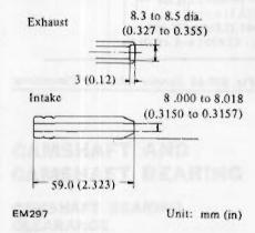
Fig. EM-41 Valve guide dimensions
