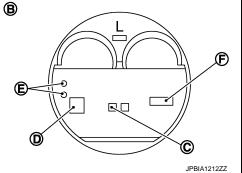
CYLINDER BLOCK DISTORTION
