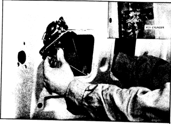
Fig. BF-39 Removing door lock
