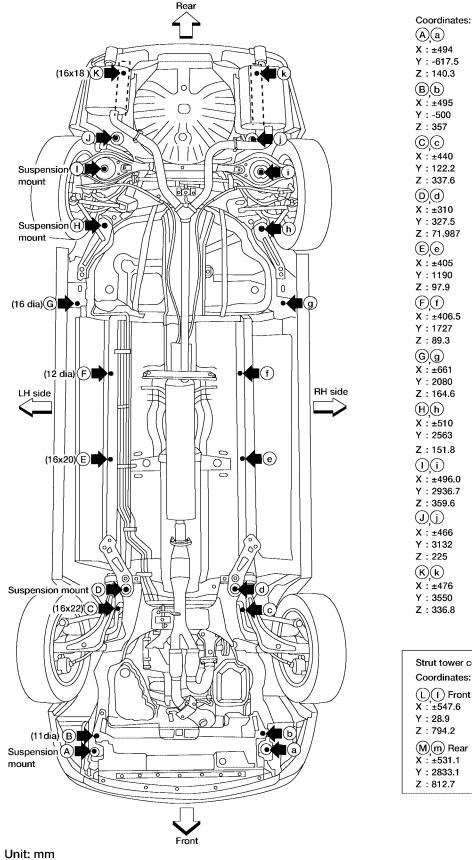
X : ±495 Y:-500 Z:357  $\odot$ X : ±440 Y:122.2 Z:337.6  $\bigcirc d$ X : ±310 Y:327.5 Z:71.987 Ee X : ±405 Y:1190 Z:97.9 E,f X:±406.5 Y:1727 Z:89.3 Gg X : ±661 Y : 2080 Z:164.6 Hh X : ±510 Y : 2563 Z:151.8 ()X:±496.0 Y: 2936.7 Z:359.6 J.J X:±466 Y:3132 Z : 225 (K)(k) X:±476 Y : 3550 Z:336.8
