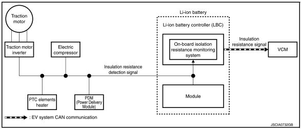
LI-ION BATTERY HEATER CONTROL SYSTEM
