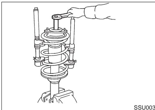
3. Remove piston rod lock nut.
