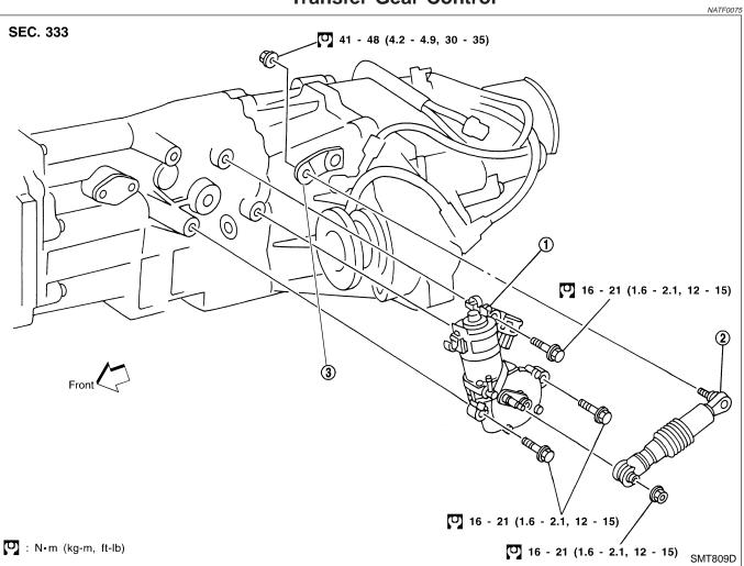
1. Actuator 2. Actuator lever 3. Outer shift lever
