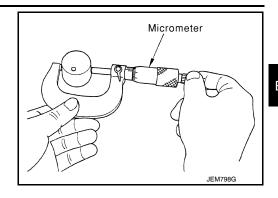
Valve Lifter Hole Diameter
