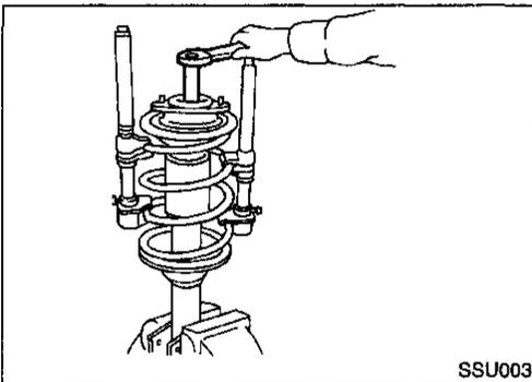
3. Remove piston rod lock nut. AX
