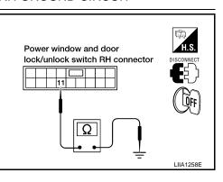
7. CHECK FRONT POWER WINDOW MOTOR RH LIMIT SIGNAL
