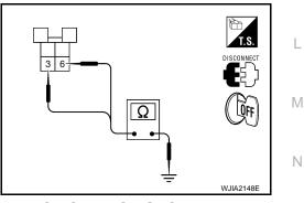
11. CHECK VARIABLE BLOWER CONTROL (FRONT) POWER SUPPLY CIRCUIT FOR SHORT
