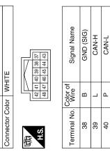
IPDM E/R (INTELLIGENT POWER DISTRIBUTION MODULE ENGINE ROOM)
